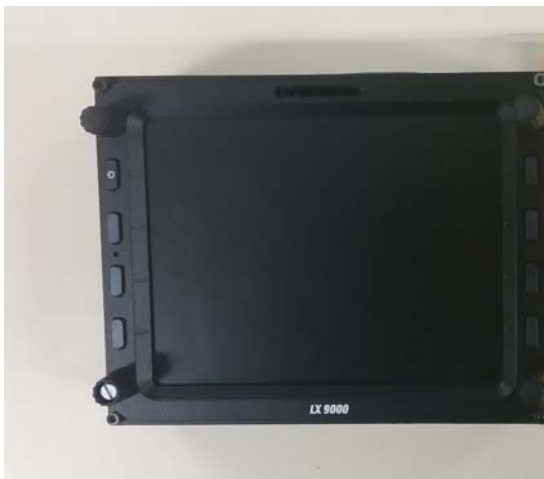
Alcune tipologie di apparati non protetti contenenti memorie per la registrazione dei parametri di volo.
