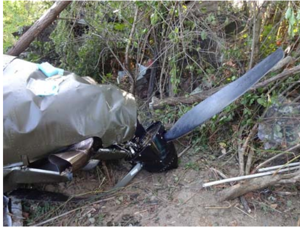
L'elica con danni compatibili con un regime di rotazione nullo.
