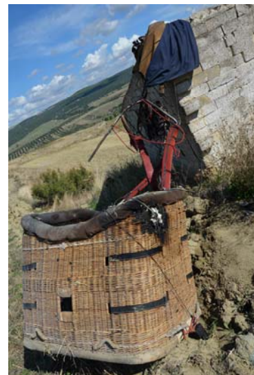
Nella foto a sinistra si vede l'incendio (macchia arancione) sviluppatosi a bordo della mongolfiera D-OJZW; nella foto a destra si notano le tracce di incendio sulla cesta dell'aeromobile.
