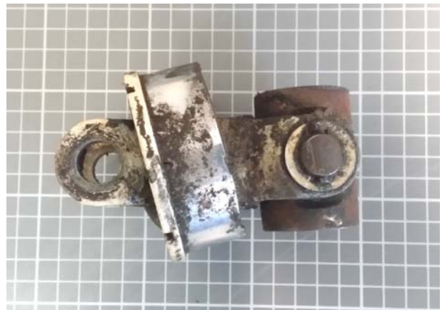
Let 410 E7-WDT: l'interno del cockpit con visibili le tracce di incendio (foto a sinistra); porzione di stelo della gamba del carrello collassato, esaminata nei laboratori ANSV (foto a destra).
