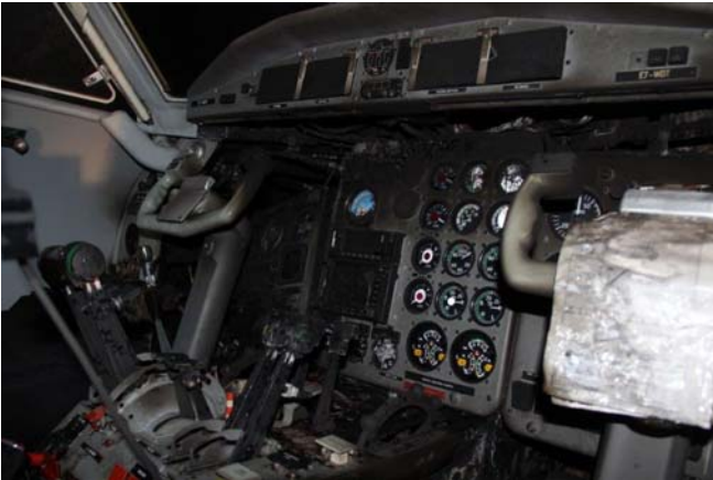
Let 410 E7-WDT: l'interno del cockpit con visibili le tracce di incendio (foto a sinistra); porzione di stelo della gamba del carrello collassato, esaminata nei laboratori ANSV (foto a destra).
